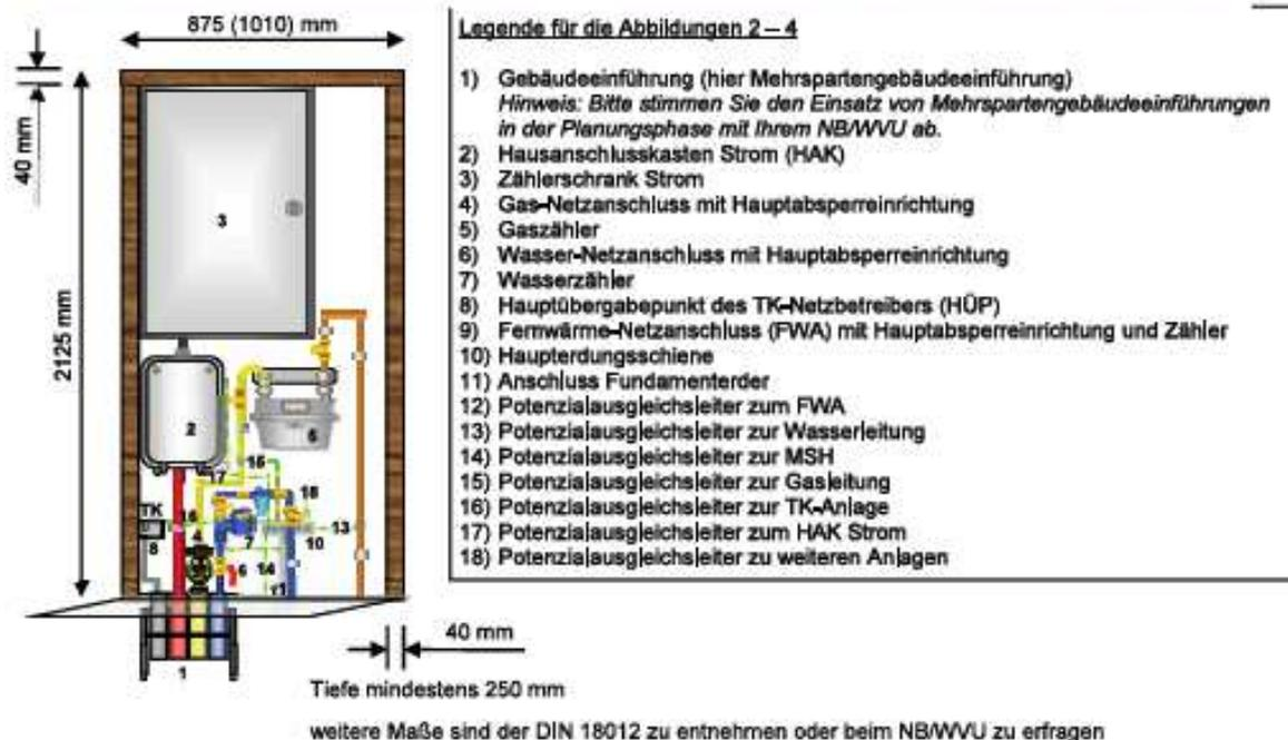
Abbildung 4: Die Hausanschlussnische für eine Wohneinheit (bei nicht unterkellerten Gebäuden)
